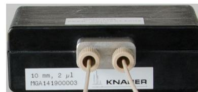
**Fig.4** Cellule d'écoulement
