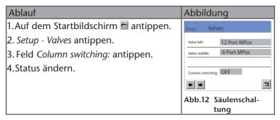
**Ergebnis:** Beide Ventile werden synchron geschaltet.
