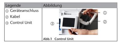
Die Control Unit ist ein Display mit Touchscreen-Funktion und wird als optionale Bedieneinheit für die L-Geräte der Produktlinie AZURA angeboten. Mit der Control Unit lässt sich jeweils ein AZURA-Element bedienen. Um ein anderes Gerät zu bedienen, müssen Sie das Kabel umstecken.
