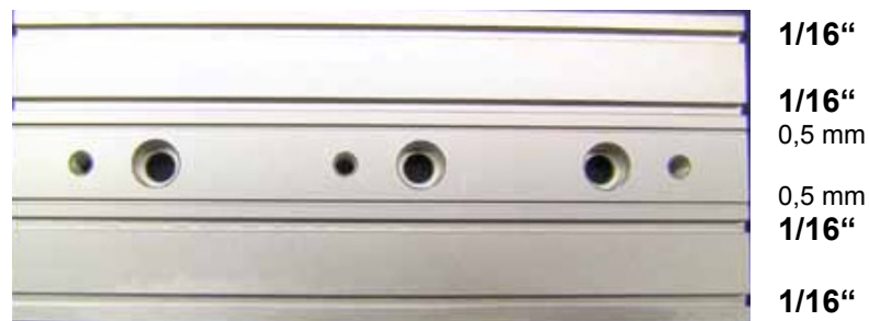
Abb. 10 Fixierung der Kapillaren an der Halterungsaußenseite
