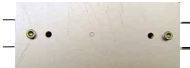
Abb. 11 Fixierte Kapillaren mit 10mm Schraube
