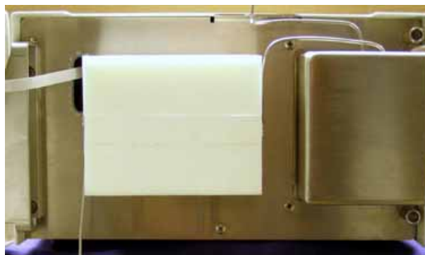
Abb. 4 Nachsäulenkühlung mit Isolierkappe
