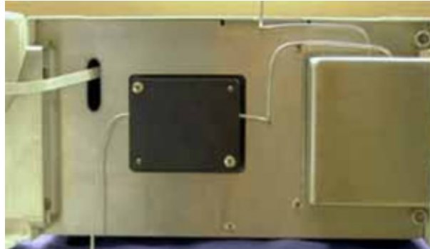
Abb. 3 Kapillarführung der Nachsäulenkühlung
