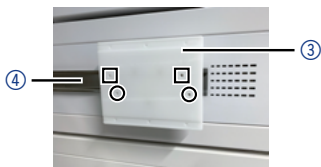
Abb. 8 AZURA Organizer an der AZURA Click Schiene (die Löcher für die Montage der AZURA pH-Flusszelle sind jeweils mit einem Quadrat und einem Kreis markiert)
