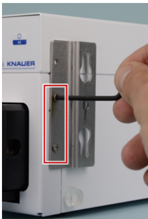
Fig. 33 UVD 2.1S & mount. bracket
