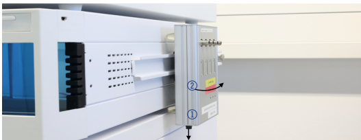
Abb. 6 Abnehmen des Geräts am Beispiel der Interface Box
